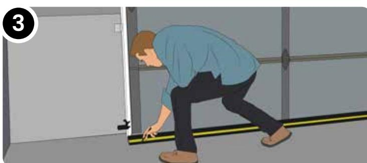
Von der Innenseite der Garage mit geschlossenem Tor, drücken Sie die Bodenabdichtung gegen die Rückseite des Garagentors, die Erhöhung muss das Tor berühren. Markieren Sie eine Linie mit einem Bleistift oder geeigneten Markier entlang der Rückkante der Bodenabdichtung.
