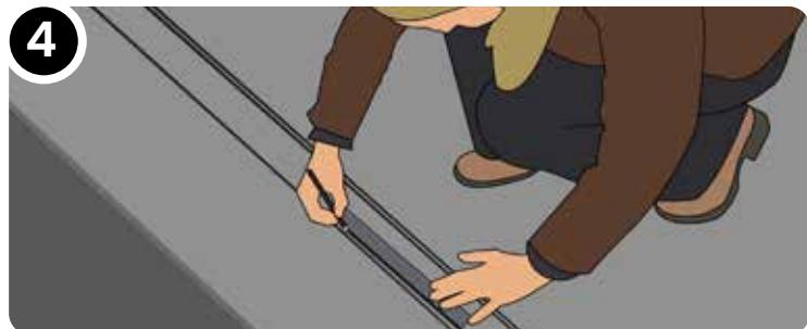
Öffnen Sie das Tor und markieren Sie eine Linie entlang der Vorderkante der Bodenabdichtung. Entfernen Sie die Bodenabdichtung und markieren Sie zwei parallele Linien ungefähr 10mm an der Innenseite der existierenden Linien. Markieren Sie eine Zickzack-Linie in der Mitte davon.
