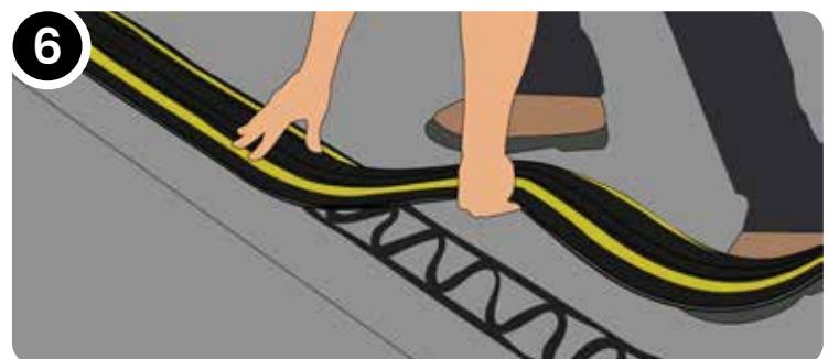
Begin met het plaatsen van het drempelprofiel vanaf één kant. Druk het profiel steeds goed aan, zorg dat het op ieder punt strak contact maakt met de vloer. Doe dit over de hele lengte. Het doel is om een goede waterdichte verbinding tot stand te brengen. Verwijder, zodra het profiel goed aangedrukt op de gewenste plek ligt, eventuele overtollige kit met een droge doek.
