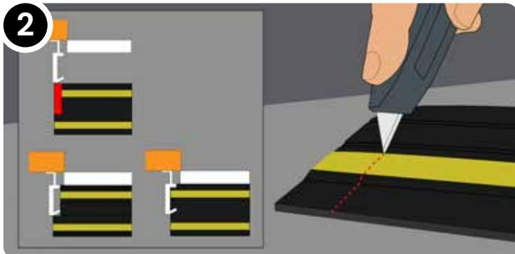
Beoordeel of aan de binnenzijde van de deur extra ruimte is om het drempelprofiel op de vloer tot om de stijl van de garagedeur te laten vallen. Zo ja, hou dan ca. 40mm extra lengte aan iedere kant van het profiel aan. Dit heeft als voordeel dat het drempelprofiel mooi aansluit. Is de extra lengte binnen er niet/niet nodig, hou dan de minimaal benodigde breedte aan.
