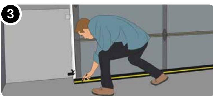
Doe de garagedeur dicht. Leg het profiel tegen de deur aan en schuif het er deels onder. Zorg dat de 'bubbelt' de deur aan de binnenzijde raakt. Markeer nu met een potlood de positie van het drempelprofiel op de vloer, langs de gehele lengte (aan binnenzijde van de garage).
