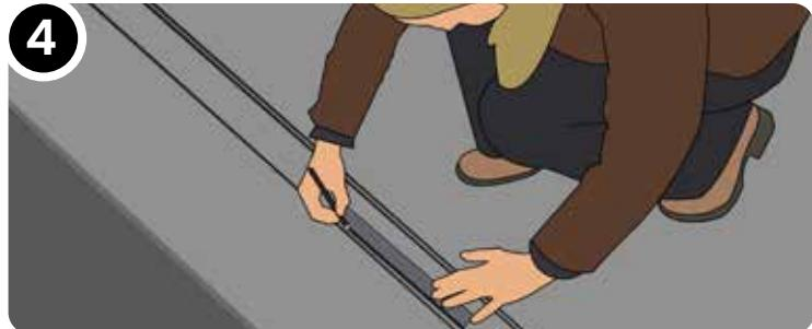
Aprire la porta e tracciare una linea lungo il bordo frontale della guarnizione.
