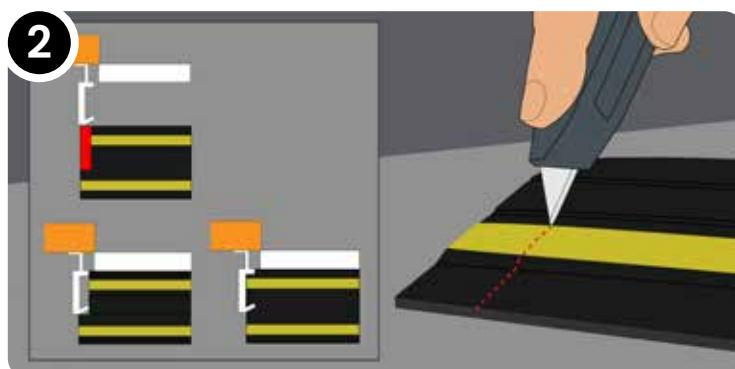
Placer le joint de seuil de sorte que le rehaussement se trouve derrière la porte de garage fermée.
