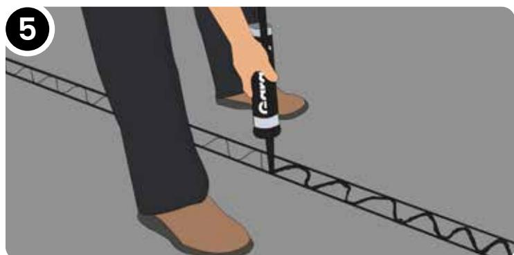
Appicare il sigillante in dotazione al pavimento seguendone due linee parallele e le linee a zig-zag disegnate con la matita. Si consiglia che la temperatura del sigillante al momento dell'applicazione sia tra i +5° C e i +25° C.
