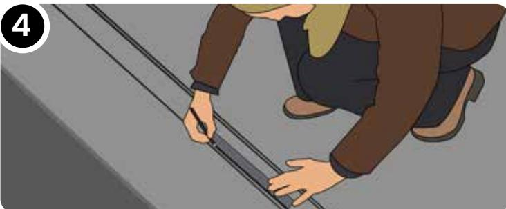
Åbn døren og lav en markering langs tætningslistens forreste kant. Fjern tætningslisten og lav to parallelle markeringer ca. 10 mm inden for eksisterende linjer. Lav dernæst en zigzaglinje mellem dem.
