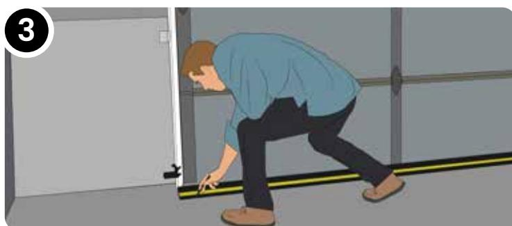
Dall'interno del garage (con la porta chiusa), spingere la guarnizione contro la parte posteriore del porta del garage con la gobba che tocca la porta. Con una matita, tracciare una linea lungo il bordo posteriore della guarnizione.
