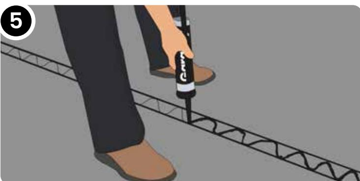
Smør sort MS Polymer lim på gulvet ved at følge de tegnede blyantslinjer. Anbefalet påsmøringstemperatur +5° C til +25° C.
