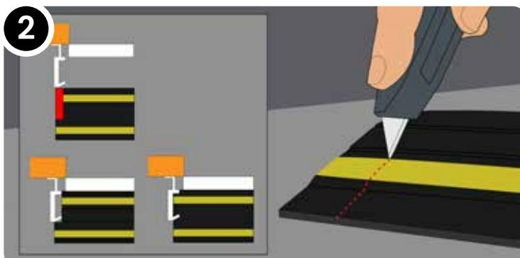
Positionierung der Bodenabdichtung, sodass bei dem geschlossenen Garagentor die Anhöhung hinter dem Garagentor liegt. Markieren Sie mit dem Bleistift die Linie, wo die Bodenabdichtung an der Rückseite des Garagentors befestigt werden muss. Das ermöglicht die korrekte Positionierung der Bodenabdichtung hinter dem Tor mit einer ausgezeichneten Abdichtung um den gesamten Rahmen. Schneiden Sie die Bodenabdichtung an beiden Enden mit einer Eisensäge oder scharfen Schere zu.
