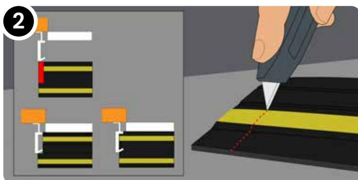
Posizionare la guarnizione della soglia in modo tale che quando la porta del garage si chiude, la gobba sia dietro alla porta del garage. Segnare con una matita dove va intagliata la guarnizione. In questo modo, verrà posizionata correttamente dietro la porta e con una perfetta tenuta attorno al telaio. Intagliare la guarnizione su entrambi i lati, con un seghetto o forbici affilate.
