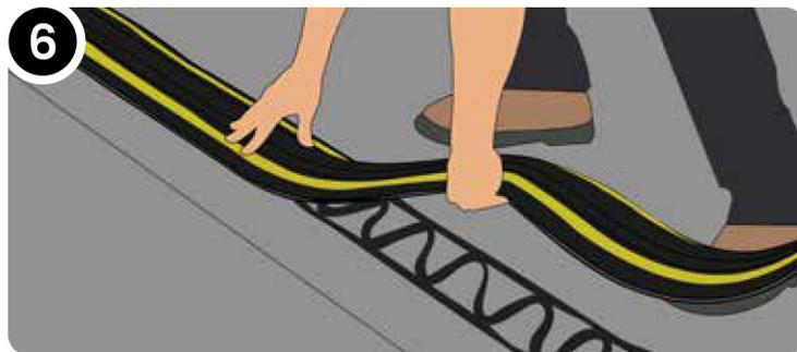
En commençant d'une extrémité, placer le joint de seuil sur le mastic, en appuyant fermement. Continuer tout le long du joint, en veillant à maintenir un bon contact tout du long. Avec un chiffon propre, essuyer l'excédent de mastic des deux côtés du joint. Laisser sécher 24 heures avant de rouler sur le joint de seuil.
