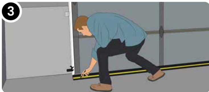
De l'intérieur du garage (porte fermée), pousser le joint contre la porte de garage, jusqu'à ce que le rehaussement la touche. Avec un crayon, marquer le sol le long de l'arrière du joint.
