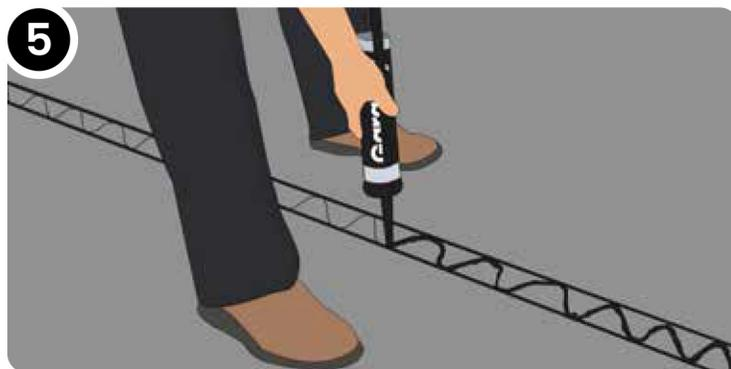
En suivant les deux lignes parallèles et celle en zigzag appliquer le mastic fourni sur le sol. Pour son application, il est conseillé que la température du mastic soit entre +5° C et +25° C.
