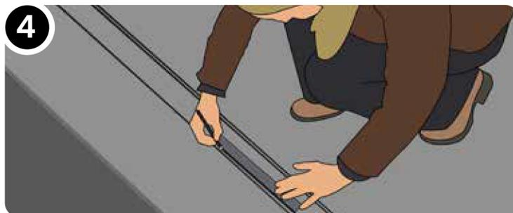
Ouvrir la porte et marquer le sol le long de l'avant du joint. Retirer le joint de sol et tracer deux lignes parallèles à environ 10 mm à l'intérieur des marques existantes. Puis tracer une ligne en zigzag entre les deux lignes.
