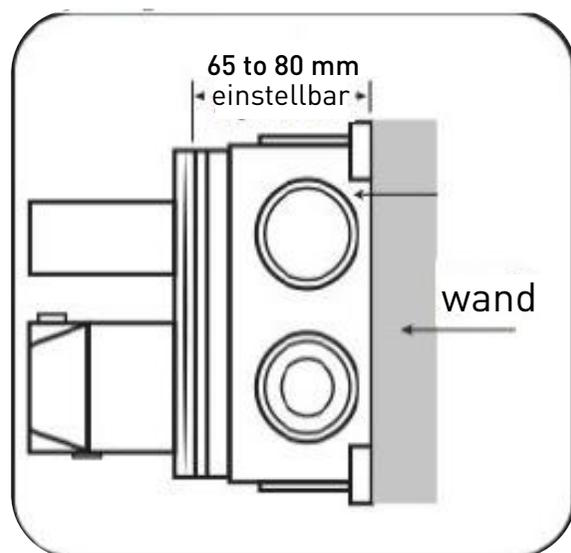
**Schritt 2:** Schließen Sie den Wasserzulauf und den -ablauf an. Befestigen Sie dann die Duscharmatur und überprüfen Sie im Anschluss die Dichtheit.
