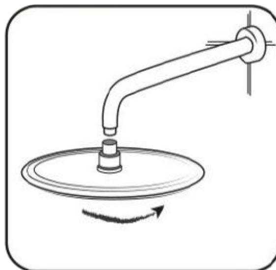
**Schritt 6:** Installieren zuletzt den Duschkopf und die Halterung.
