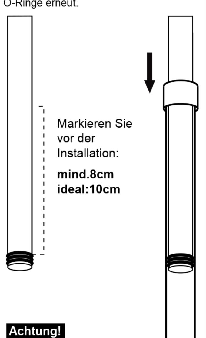
Falls die beiden Stangen ineinander schwer zu schieben bitte schmieren Sie die O-Ringe der oberen Stange mit etwas Sonnenblumenöl, Gesichtscreme usw.
