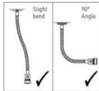
Schrauben Sie den Brauseschlauch (21) an den Mischbatteriekörper (10) und dann den Duschkopf (20) an den Brauseschlauch (21). Achten Sie darauf, dass an beiden Enden des Schlauchs (21) eine Dichtung vorhanden ist, um das System wasserdicht zu machen.
