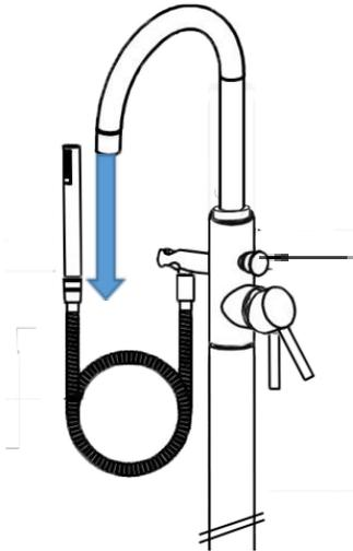
Wenn der Knopf oberhalb des Griffs gedrückt wird, funktioniert die Mischbatterie mit dem Wasserauslass am Ausguss.
