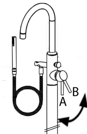
Position A stellt die geschlossene Stellung des Hahns dar (der Ausfluss ist gleich null). Wenn Sie den Griff nach oben ziehen, öffnet sich der Wasserhahn stufenweise. Der Griff stößt in Position B an, was dem maximalen Durchfluss des Mischers entspricht.
