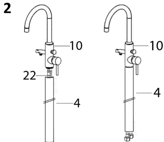
**2** Führen Sie die Zuleitungsschläuche (22) durch das Strukturrohr (4) und schrauben Sie dann den Mischkörper (10) HANDBEDIENT in das Strukturrohr (4).
