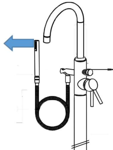
Wenn der Knopf oberhalb des Griffs gezogen wird, arbeitet die Mischbatterie mit dem Ausgang an der Handbrause.
