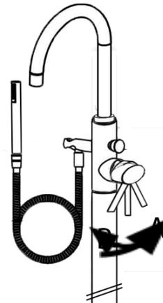
Drehen gegen den Uhrzeigersinn (A) senkt die Temperatur des austretenden Wassers. Drehen im Uhrzeigersinn (B) erhöht die Temperatur des Wassers.
