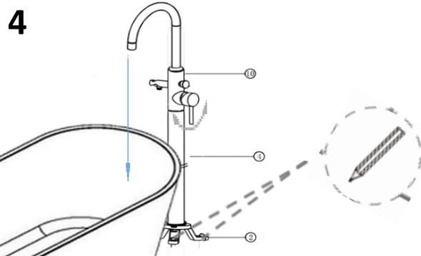
**4** Markiere mit einem Bleistift die Punkte, an denen du den Anker (2) befestigen willst. Achte darauf, dass sich unter diesen Punkten keine Rohre befinden! Nehmen Sie es heraus und schrauben Sie den Anker (2) vom Strukturrohr (2) ab.
