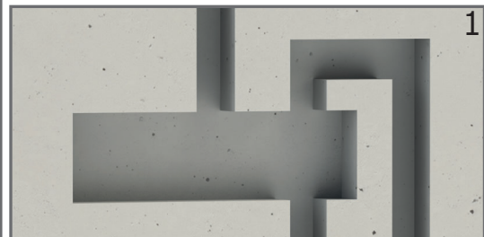
1 REALIZAR UNA PERFORACIÓN DONDE ENTRE LA CAJA BOX DE LA GRIFERÍA Y LAS TUBERÍAS DE AGUA CALIENTE Y FRÍA. DRILL A HOLE WHERE BETWEEN THE FAUCET BOX AND HOT AND COLD WATER PIPES.
