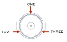
REPLACING PLUNGER SPRING FIT THE RETAINING SPRING INTO 3 GROOVES IN ORDER SHOWN.
