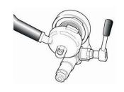
10.Solange hebeln bis Duschensieb mit der Dichtung richtig sitzt
