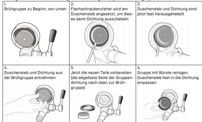
Mit der Hand das Duschensieb inklusive Dichtung einsetzen
