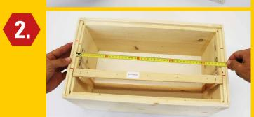
Die Leisten in den Oberen Falz legen und mit dem Maß band kontrollieren welche Leisten Paarung die passende ist.
