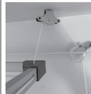
Per livellare, tirare le 4 corde fino a quando il telaio tocca il soffitto in tutti e 4 gli angoli.
