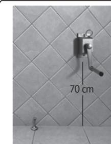
Fissare il BOBINA "K" alla parete, sotto le 2 PULEGGE A DOPPIA PARETE "J", a 70 cm dal pavimento. Per fare questo, utilizzare i 2 TACCHE E VITI PER BOBINE "L".
