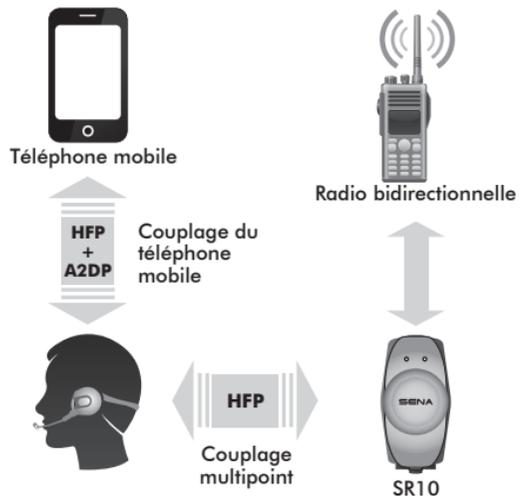
**Connexion parallèle du SR10 et d'un téléphone mobile par couplage multipoint Bluetooth**
