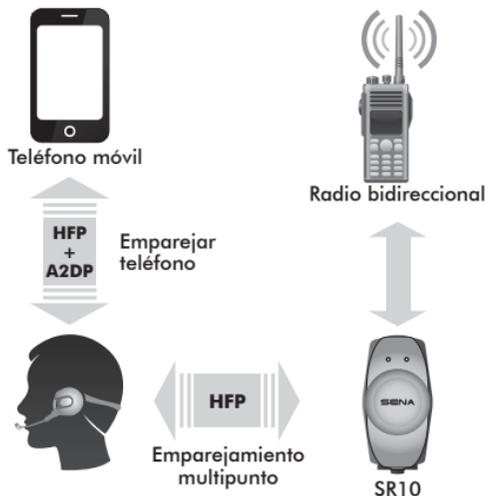
**Conexión paralela del SR10 y del teléfono móvil a través del emparejamiento multipunto**
