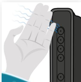
1 Approchez votre main des optiques ioniques, il est possible de sentir un léger courant d'air frais : c'est le vent ionique.
