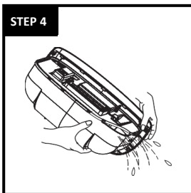
Pour the water away
