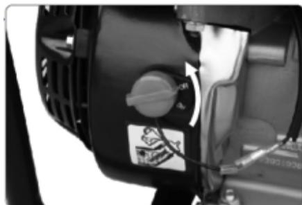
C.- Gire la palanca de la válvula de combustible a la posición OFF.
