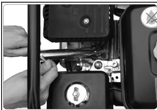
C.- Revise la bujía. Reemplácela si los electrodos están desgastados, si el aislador está agrietado o roto.
