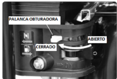
D.- Mueva la palanca obturadora lejos de la posición LENTO, alrededor de 1/3 del camino hacia la posición RÁPIDO.
