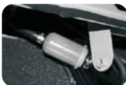
(Figura A – cambiando el filtro de combustible ubicado dentro del panel frontal una vez al año)
