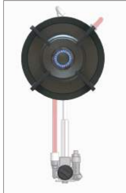
Betjeningsknap helt åben: Gasforsyning delvist åben. Kun den mindre indre ring er aktiveret.
