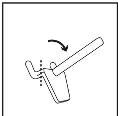
Une fois le crochet inséré jusqu'au fond, vous devez le descendre en position horizontale. Le crochet se solidifiera dans le présentoir une fois qu'il sera en bonne position.
