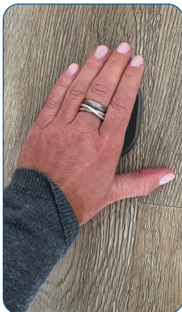
Wecken Sie das Gerät auf, indem Sie die Handfläche auf die Oberfläche des Fingerabdrucklesers legen
