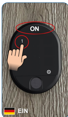
Nun leuchtet nur noch die Zahl 1, sowie die rechte Menü-Taste. Im Display erscheint ON (=Ein). Tippen Sie auf die Nummer 1, um die Autorisierung zur Nutzung des Masterpassworts zu deaktivieren und auf OFF (=Aus) umzustellen
