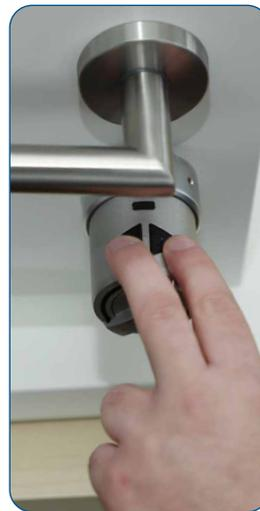
Beide Steuerungstasten gleichzeitig für mehrere Sekunden gedrückt halten: **Kinderfunktion wird wieder deaktiviert!**
