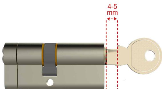
Der Schlüssel muss laut Schablone abgeschnitten werden und ca. 4-5 mm vom Zylinder hervorste-
