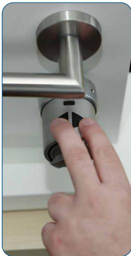
Beide Steuerungstasten gleichzeitig für mehrere Sekunden gedrückt halten: **Kinderfunktion wird aktiviert!**
