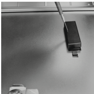
Illustration 3: comment ouvrir le compartiment de la batterie
