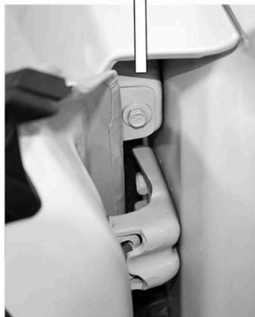
Open door and remove M10 bolt.
