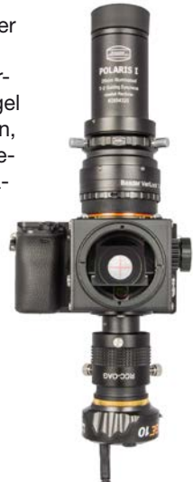
Off-Axis-Guider unten am BFM II. Das Prisma schaut immer unter dem Spiegel hindurch.
