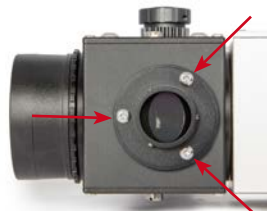
Die Justierschrauben für den unteren Anschluss des BFM II.
