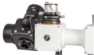
Die Anschlussgewinde sind über die vier Madenschrauben verstellbar. So kann Zubehör wie hier der DADOS-Spektrograf bündig auf das Gehäuse ausgerichtet werden, oder der ganze Ansatz verdreht werden, falls er fest mit dem Teleskop verschraubt ist.
