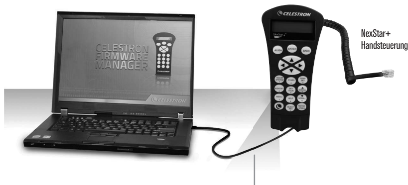
Abbildung 12.2 Aktualisieren der Handsteuerungs-Firmware
