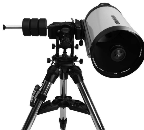
Figure 6 Équilibrage de la monture
