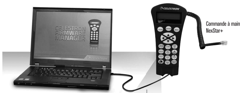
Figure 12.2 Mettre à jour le micrologiciel de la commande à main
