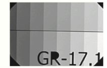
Abb. / Fig. 13: Röntgensichtbarkeit printo dent ® GR-17.1 temporary It im Vergleich zu einer Aluminiumtreppe (ISO 4049)/ Radiopacity of printo dent ® GR-17.1 temporary It in comparison to aluminum stairs (ISO 4049).
