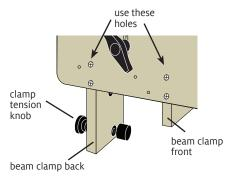
FIGURE 2: CLAMPS FOR A STRAIGHT BEAM
