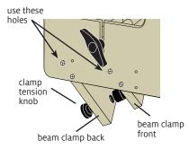
FIGURE 1: CLAMPS FOR A SLANTED BEAM
