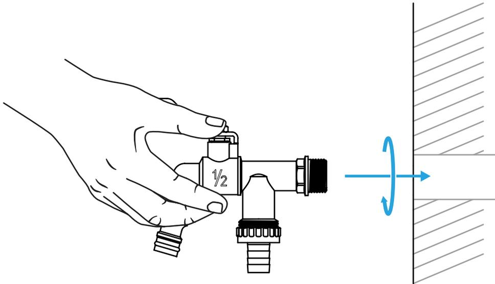
**Drehe den Wasserhahn ohne Dichtungsmaterial so weit es geht im Uhrzeigersinn in den Wandanschluss hinein.**
