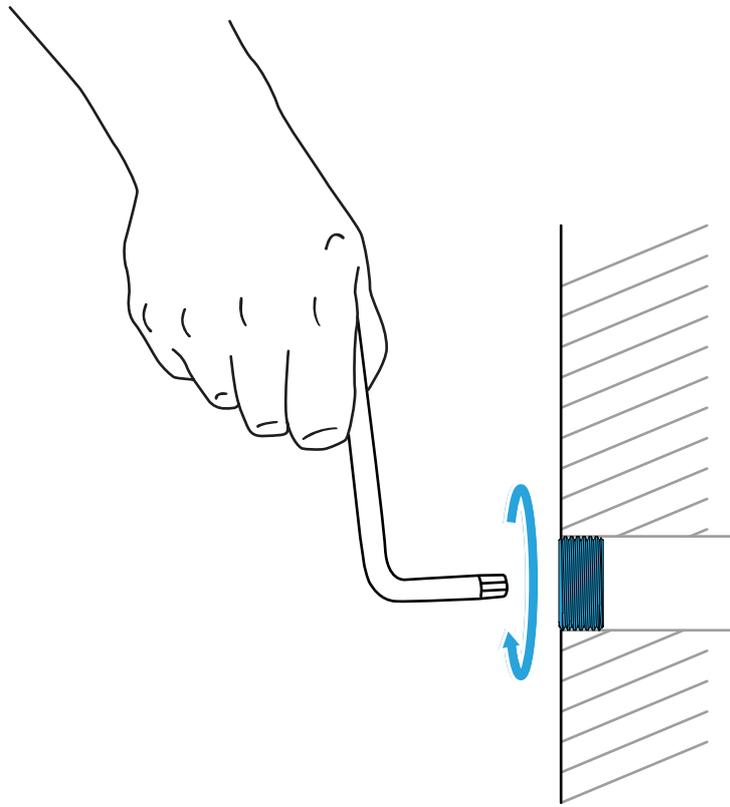
**Anschließend wird mit Hilfe eines 12mm Innensechskantschlüssels der Adapter nochmals handfest eingeschraubt.**
