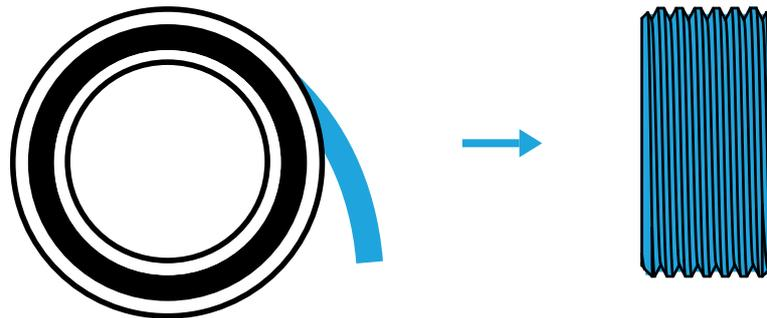
**Gebe das PTFE-Tape von der Rolle auf das Gewinde und wickle es in Gewinderichtung um den G $\frac{3}{4}$ " Adapter.**
