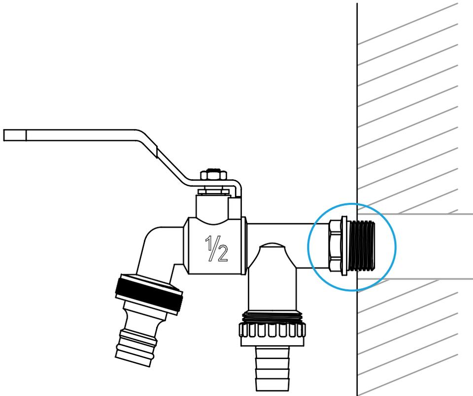
**Stelle die Wasserzufuhr an, um die Dichtigkeit zu prüfen.**
