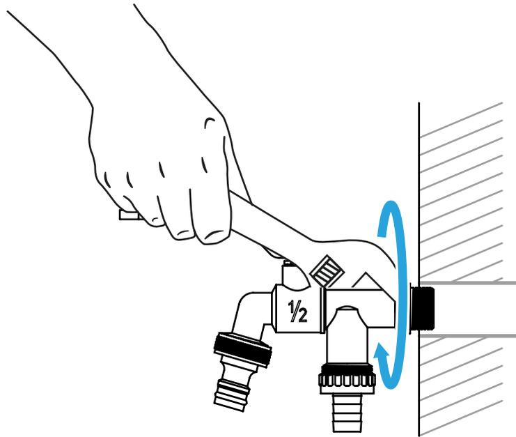
**Nimm anschließend die Wasserrohrpumpenzange und drehe den Hahn im Uhrzeigersinn bis zu dem vorher ermittelten Abstand hinein, so dass dieser gerade ausgerichtet ist.**
