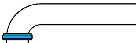
**Lege die untere Dichtung auf den Bördelrand des Wandrohres.**
