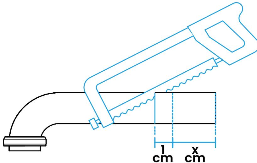
Übertrage die gemessene Strecke auf das hintere Ende des Wandrohres und erweitere diese um noch 1 cm ( $x \text{ cm} + 1 \text{ cm}$ ). Kürze an dieser Stelle das Rohr mit einer Metallsäge.
