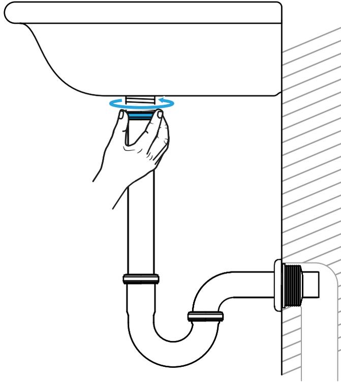
**Verschraube die Überwurfmutter des Tauchrohrs mit dem Waschbeckenabfluss.**
