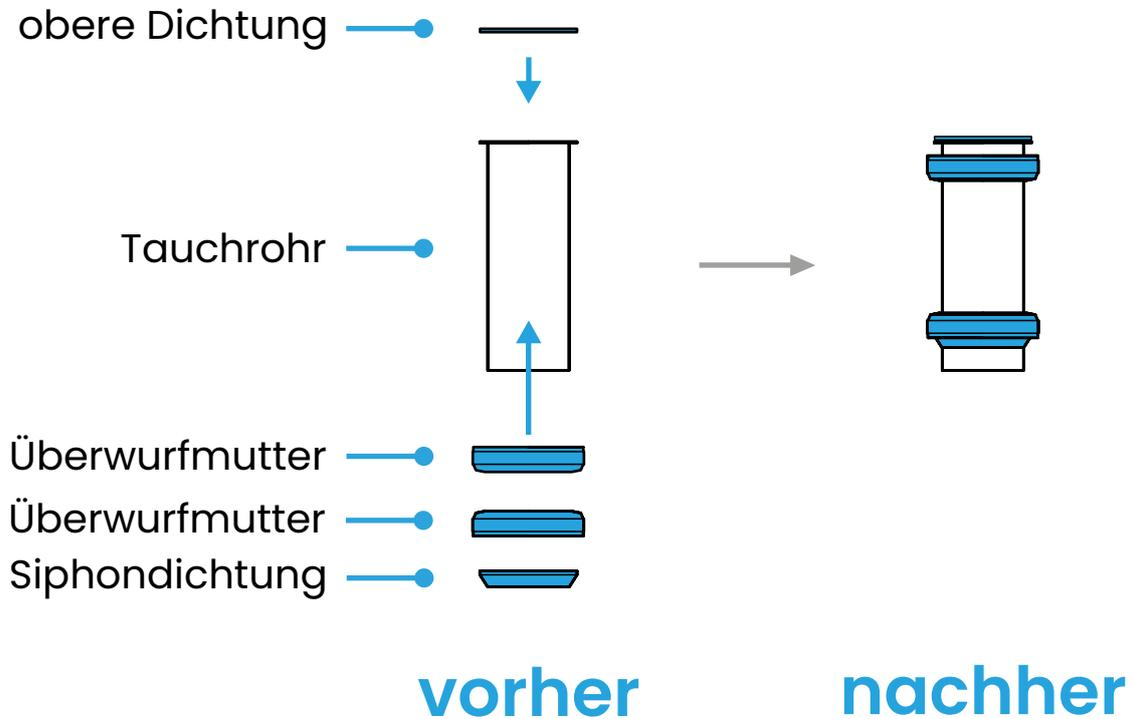
**Lege die obere Dichtung auf den Bördelrand des Tauchrohres.**
