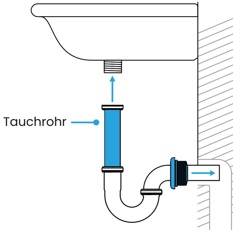
**Verschraube alle Einzelteile des Siphons miteinander. Schiebe das Wandrohr durch die Wandrosette und Gummirosette Richtung Abwasseranschluss.**
