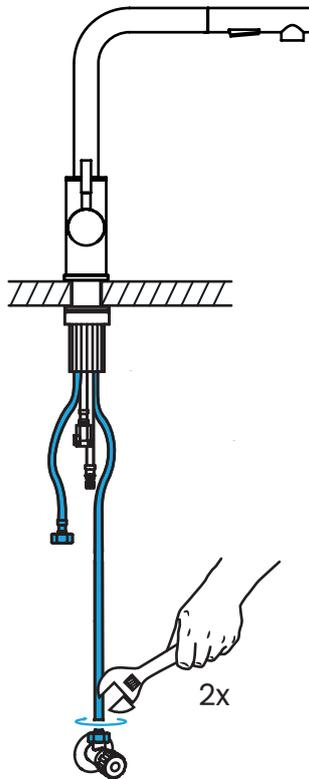
**Montiere mit einem Maulschlüssel die farblich markierten Flexschläuche auf die entsprechenden Eckventile für Kalt- und Warmwasser.**
