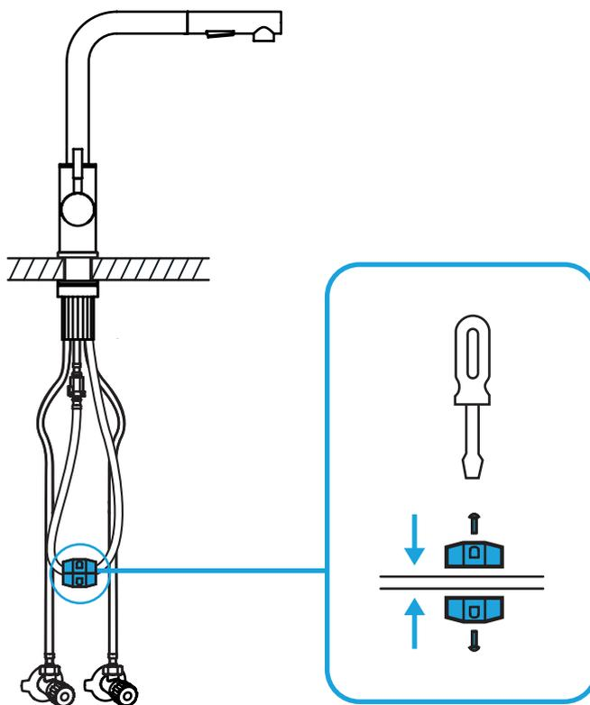
**Bringe das Gegengewicht, mit dem Schraubendreher an dem tiefst hängenden Punkt des Brauseschlauches an.**
