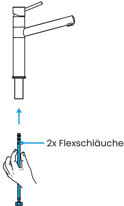
**Stecke die Flexschläuche von unten durch die Öffnung des Halterungsgewindes und montiere diese an die Armatur.**
