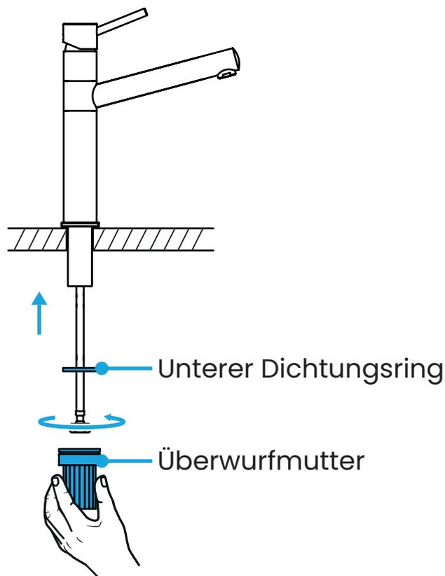
**Greife mit einer Hand den oberen Teil der Armatur und schraube von unten, die Überwurfmutter zusammen mit dem unteren Dichtungsring an das Halterungsgewinde.**
