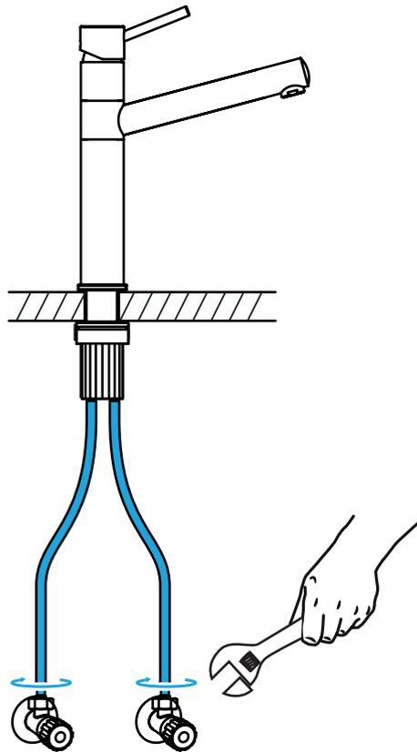
**Montiere mit einem Maulschlüssel die beiden Flexschläuche auf die entsprechenden Eckventile für Kalt- und Warmwasser.**
