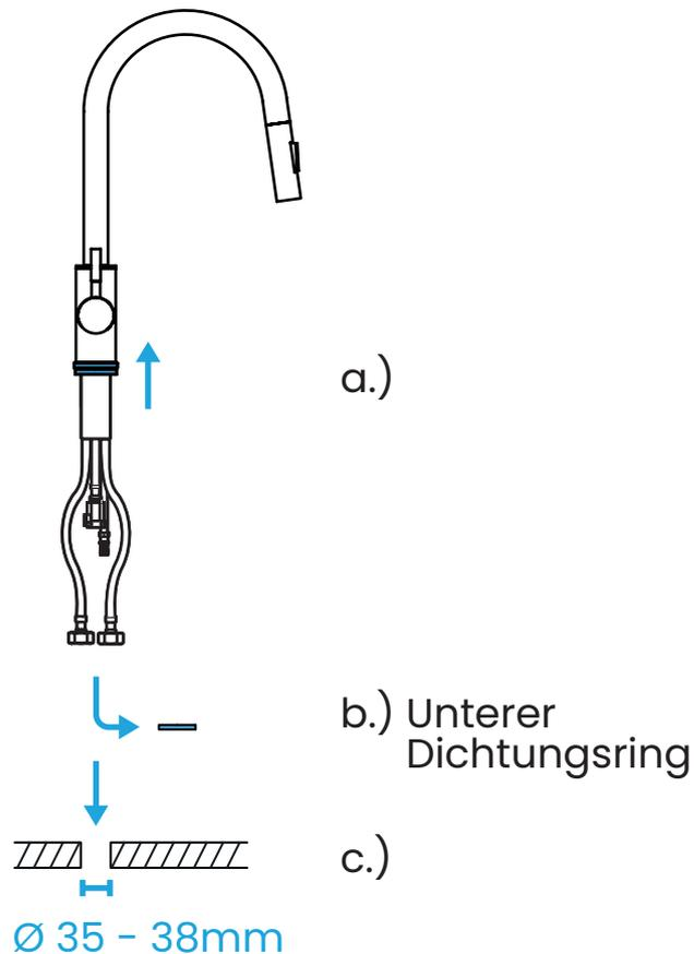
**Drücke, falls nötig, die Basisplatte und den oberen Dichtungsring am Halterungsgewinde nach oben.**
