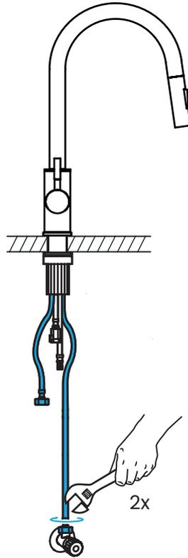
**Montiere mit einem Maulschlüssel die farblich markierten Flexschläuche auf die entsprechenden Eckventile für Kalt- und Warmwasser.**
