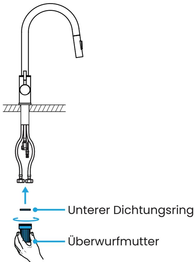
**Greife mit einer Hand den oberen Teil der Armatur und schraube die Überwurfmutter zusammen mit dem unteren Dichtungsring von unten an das Halterungsgewinde.**
