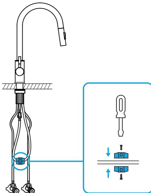
**Bringe das Gegengewicht, mit dem Schraubendreher an dem tiefst hängenden Punkt des Brauseschlauches an.**
