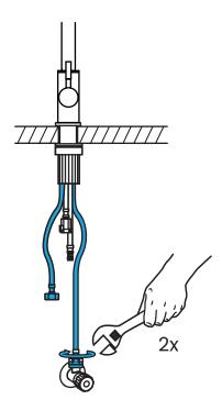
Montiere mit einem Maulschlüssel, die farbig markierten Flexschläuche auf die entsprechenden Eckventile für Kalt- und Warmwasser.
