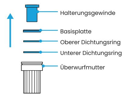
Nehme die Überwurfmutter und ziehe die darin verstauten Einzeltelteile ab. Lege, die Basisplatte, das Halterungsgewinde, den oberen und den unteren Dichtungsring, sowie die Überwurfmutter zur Seite.
