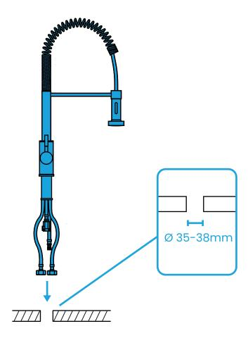
Platziere anschließend die Armatur in die dafür vorgesehene Aussparung.
