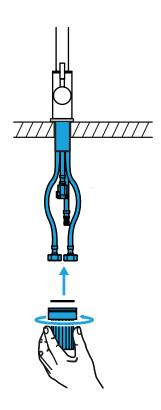
Greife mit einer Hand den oberen Teil der Armatur und schraube die Überwurfmutter zusammen mit dem unteren Dichtungsring von unten an den Halterungsgewinde.
