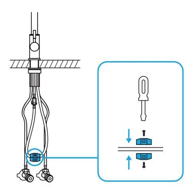
Bringe das Gegengewicht an dem tiefst hängenden Punkt des Brauseschlauches an.
