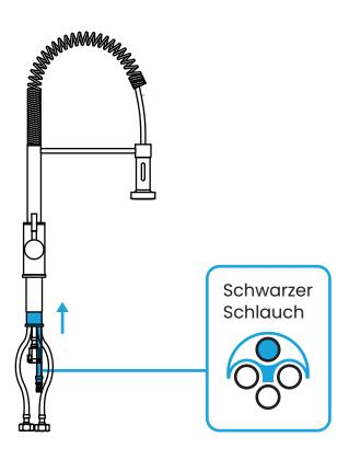
Nachdem die Schläuche eingedreht sind, schiebe das Unterteilungselement über diese. Fädle den schwarzen Schlauch durch die breite Aussparung.
