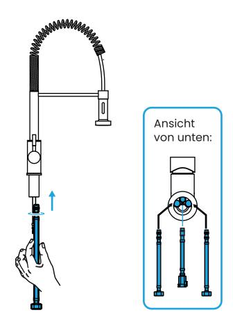
Drehe die zwei Flexschläuche und den Brauseschlauch von unten in die Armatur.
