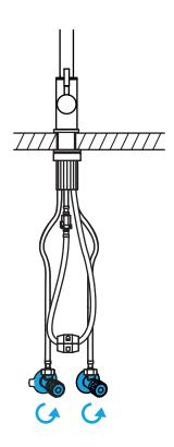
Öffne den Hauptwasserhahn, und die beiden Eckventile. Lasse bei der Erstinbetriebnahme das Wasser sowohl auf kalter, als auch auf heißer Stellung für jeweils 1 Minute laufen.
