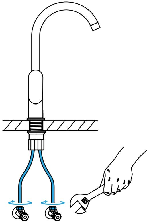
**Montiere mit einem Maulschlüssel die beiden Flexschläuche auf die entsprechenden Ventile für Kalt- und Warmwasser.**
