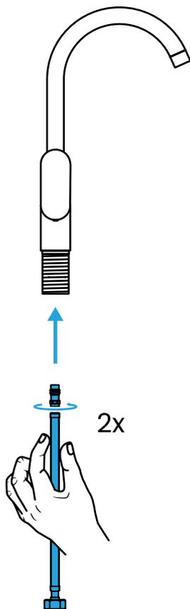
**Stecke die flexiblen Zulaufschläuche von unten durch die Öffnung des Gewindenippels und montiere diese an die Armatur.**
