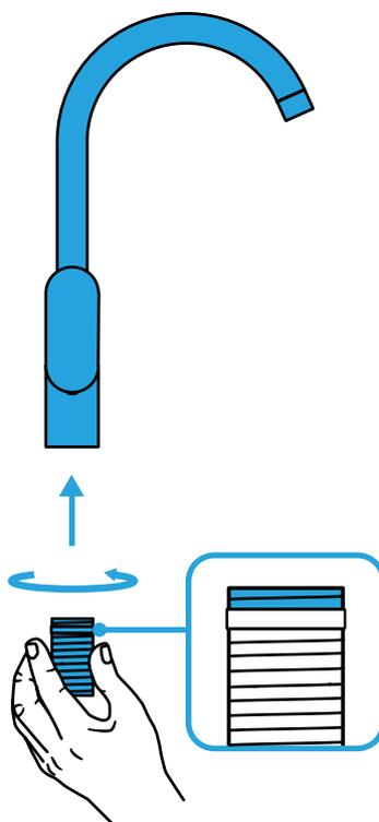
**Trage für eine sichere Montage die Schutzhandschuhe. Schraube den Gewindenippel im Uhrzeigersinn handfest in die Armatur.**
