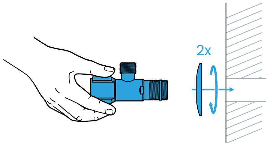
**Stecke das Gewinde des Eckventils bis zum Anschlag durch die Wandrosette. Das Ventil anschließend mit der Hand locker im Uhrzeigersinn in die Wand einschrauben.**
