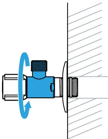
**Anschließend kann das Ventil in die gewünschte Position ausgerichtet werden.**
