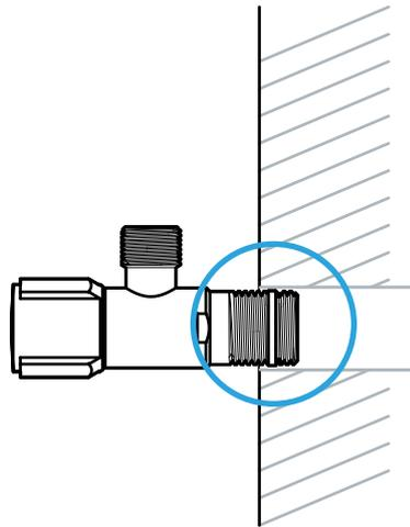
**Schließe das Eckventil, stelle einen Eimer darunter und drehe anschließend den Haupthahn auf. Öffne das Eckventil nur, wenn ein geeignetes Saniärgerät angeschlossen ist! Prüfe das Eckventil auf Dichtigkeit.**
