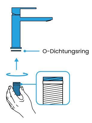
Trage für eine sichere Montage die Schutzhandschuhe. Prüfe, ob der O-Dichtungsring ordnungsgemäß an der Unterseite der Armatur angebracht ist. Drehe das Halterungsgewinde im Uhrzeigersinn in der Armatur fest.
