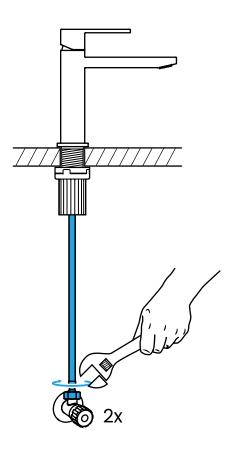
Montiere mit einem Maulschlüssel die Flexschläuche auf die entsprechenden Ventile für Kalt- und Warm-wasser.
