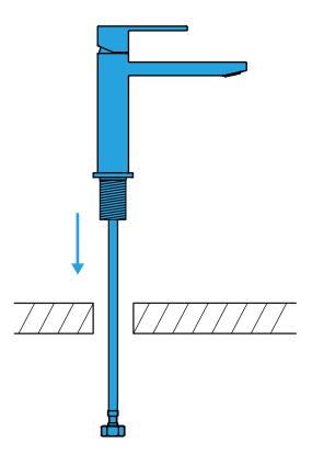
Platziere anschließend die Armatur in die dafür vorgesehene Aussparung.
