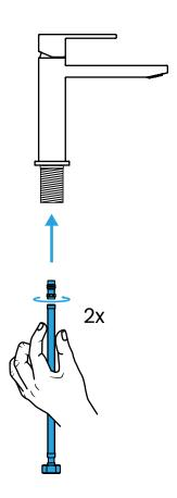
Stecke die flexiblen Zulaufschläuche von unten durch die Öffnung des Halterungsgewindes und montiere diese an die Armatur.
