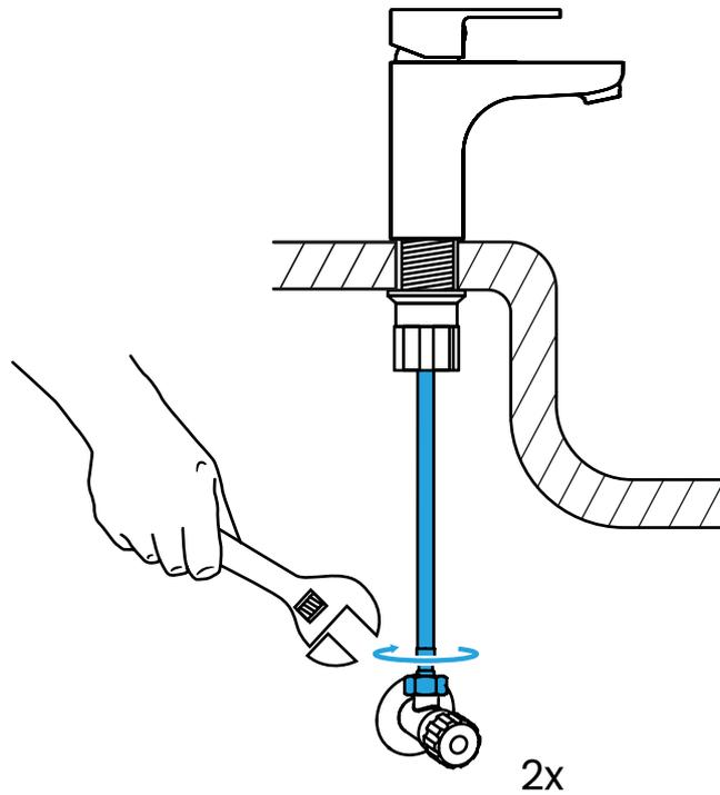
**Montiere mit einem Maulschlüssel die Flexschläuche auf die entsprechenden Ventile für Kalt- und Warmwasser.**
