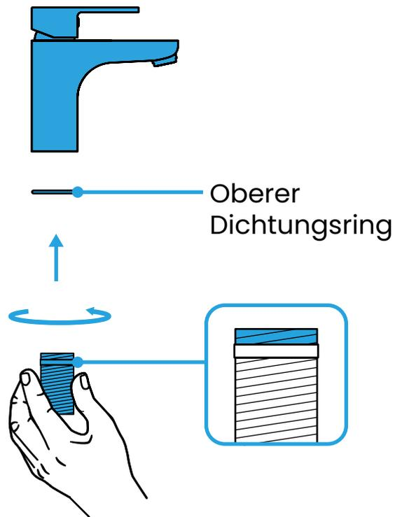
**Drehe das Halterungsgewinde im Uhrzeigersinn in der Armatur fest.**
