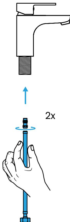
Stecke die flexiblen Zulaufschläuche von unten durch die Öffnung des Halterungsgewindes und montiere diese an die Armatur.
