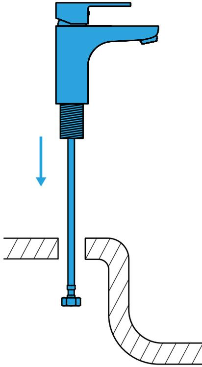
**Platziere anschließend die Armatur in die dafür vorgesehene Aussparung.**
