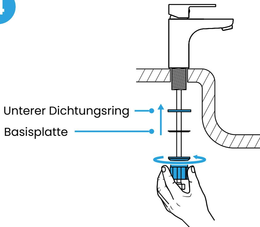
**Halte den oberen Teil der Armatur mit einer Hand fest und schraube die Überwurfmutter zusammen mit dem unteren Dichtungsring und der Basisplatte von unten an das Halterungsgewinde.**
