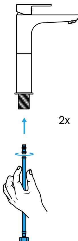
**Stecke die flexiblen Zulaufschläuche von unten durch die Öffnung des Halterungsgewindes und montiere diese an die Armatur.**
