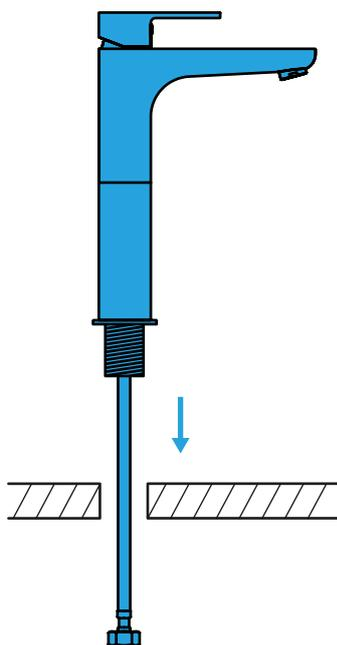
**Platziere anschließend die Armatur in die dafür vorgesehene Aussparung.**
