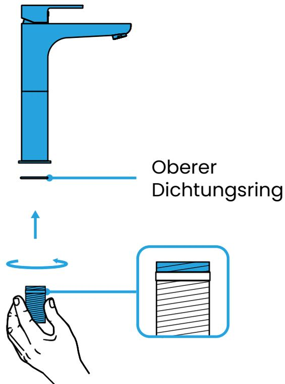
**Drehe das Halterungsgewinde im Uhrzeigersinn in der Armatur fest.**
