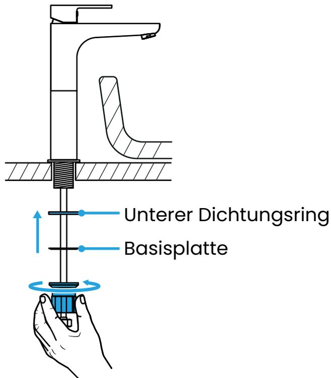
**Halte den oberen Teil der Armatur mit einer Hand fest und schraube die Überwurfmutter zusammen mit dem unteren Dichtungsring und der Basisplatte von unten an das Halterungsgewinde.**
