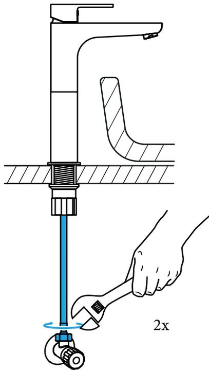
**Montiere mit einem Maulschlüssel die Flexschläuche auf die entsprechenden Ventile für Kalt- und Warmwasser.**
