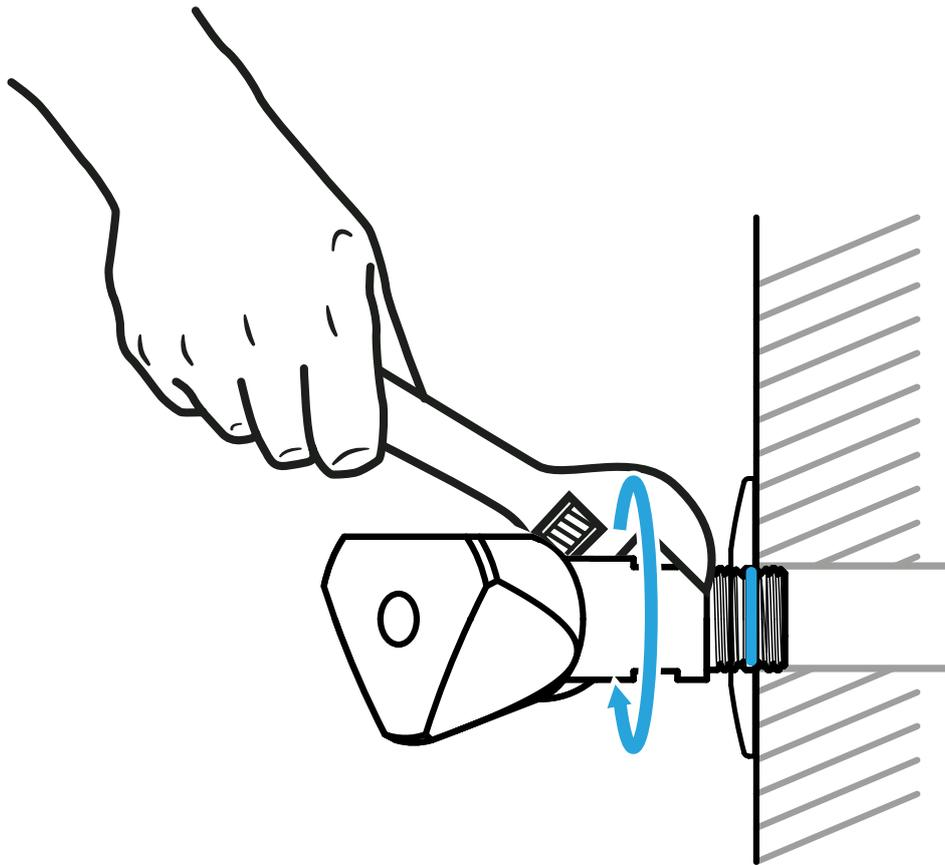
**Mit einem Maulschlüssel am hinteren Teil des Eckventiles ansetzen und fest eindrehen bis der Dichtungsring in der Aufnahme verschwindet.**
