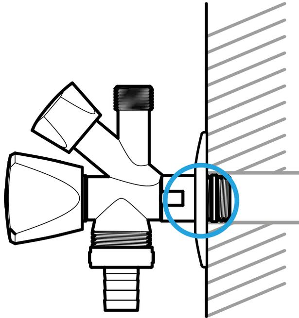
**Schließe das Eckventil, stelle einen Eimer darunter und drehe anschließend den Haupthahn auf. Öffne das Eckventil nur, wenn ein geeignetes Santiärgerät angeschlossen ist! Prüfe das Eckventil auf Dichtigkeit.**
