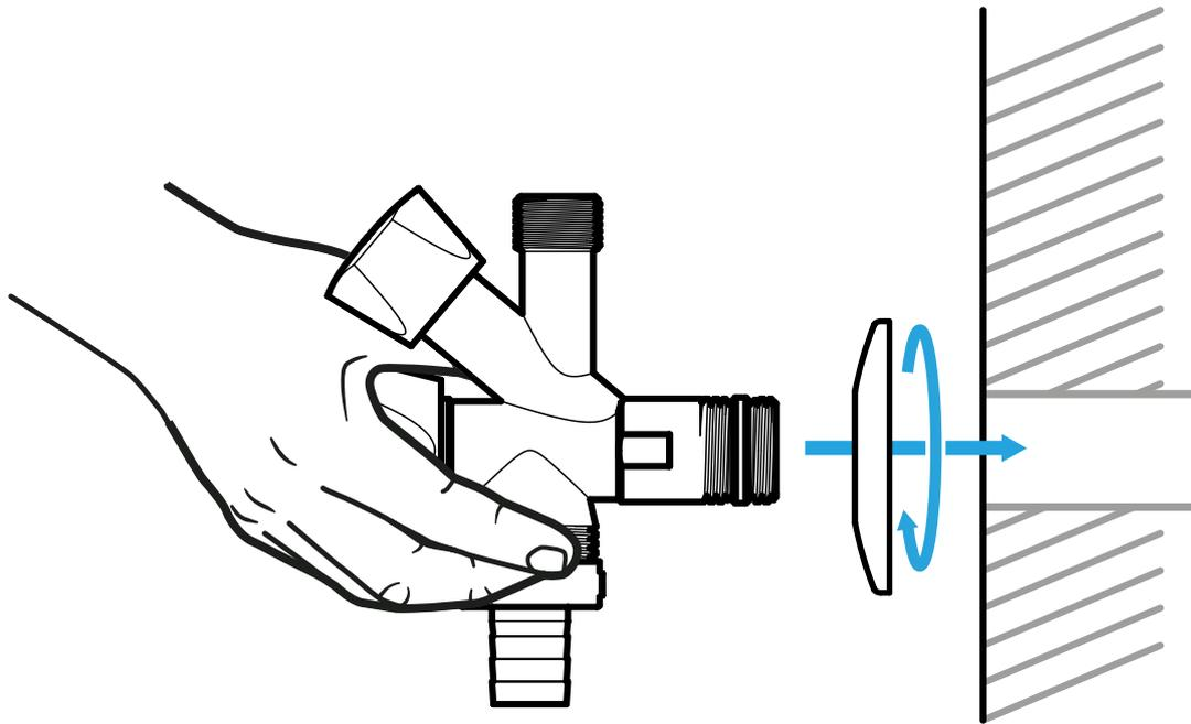
Stecke das Gewinde des Kombi-Eckventils bis zum Anschlag durch die Wandrosette.
