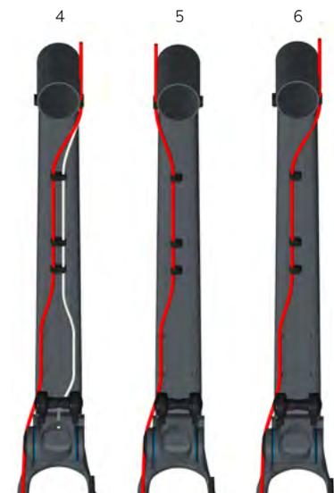
Damit sich der Hinterbau über den gesamten Federweg frei bewegen kann, ist es wichtig, dass die Bremsleitung nach dem letzten Befestigungspunkt im Hinterbau einen kleinen Bogen macht. Wir empfehlen, Züge und Leitungen zu montieren, während der Dämpfer noch nicht eingebaut ist – so kannst du einfach überprüfen, ob sich der Hinterbau frei bewegen kann, ohne die Leitungen zu spannen.
