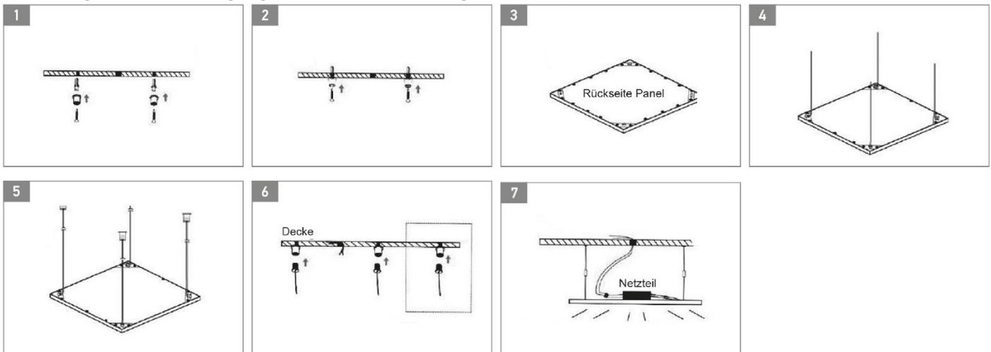
**Hinweis:** Bei LED Flächenleuchten mit einer Länge von über 100 cm empfehlen wir die Befestigung ca. 30 cm nach innen versetzt. Bei Flächenleuchten der Größe 120x60 cm empfehlen wir die doppelte Menge Seilabhängungen.
