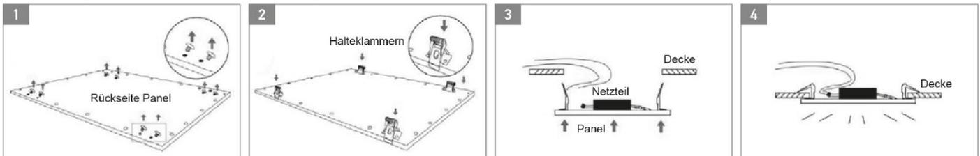
**Hinweis:** Bei LED Flächenleuchten mit einer Länge von über 100 cm empfehlen wir die Befestigung ca. 30 cm nach innen versetzt. Bei Flächenleuchten der Größe 120x60 cm empfehlen wir die doppelte Menge Halteklammern.
