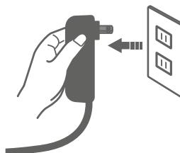
Lorsque vous utilisez la télécommande pour éteindre l'appareil, sachez qu'il n'est pas éteint correctement. Si l'appareil n'est pas utilisé pendant une longue période, assurez-vous de débrancher la fiche principale de la prise de courant.
