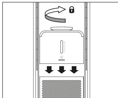
4. Setze schließlich den Deckel mit dem angebrachten Filter wieder an seinen Platz, bis er magnetisch am Hauptkörper einrastet.
