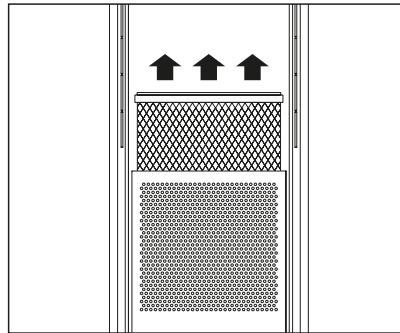
2. Entferne den alten Filter vorsichtig und mit minimalem Kraftaufwand aus dem Deckel.
