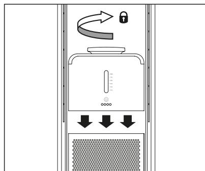
4. Enfin, remettez le couvercle avec le filtre en place jusqu'à ce qu'il s'enclenche magnétiquement sur le corps principal.
