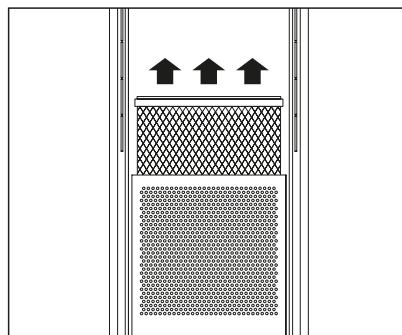
1. Levante la tapa con el filtro adjunto con cuidado. La cubierta se une magnéticamente al cuerpo principal.
