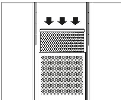
3. Packe den neuen Filter aus und befestige diesen am Deckel (einrasten, nicht schrauben).
