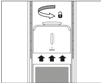
1. Hebe den Deckel mit dem angebrachten Filter vorsichtig an. Die Abdeckung wird magnetisch am Hauptkörper befestigt.
