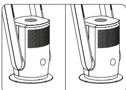
Ouvrez/déverrouillez le couvercle dans le sens inverse des aiguilles d'une montre.
