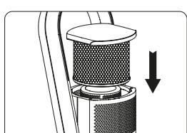
Bringen Sie die Abdeckung mit dem angebrachten Filter an und verriegeln Sie sie am Hauptgehäuse.
