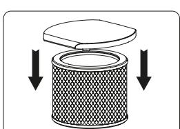
Setzen Sie den HEPA14-Filter in den Deckel ein.
