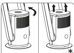
Entriegeln Sie den Deckel gegen den Uhrzeigersinn
