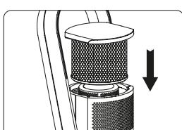
Appliquez le couvercle avec le filtre attaché et verrouillez-le sur le corps principal.
