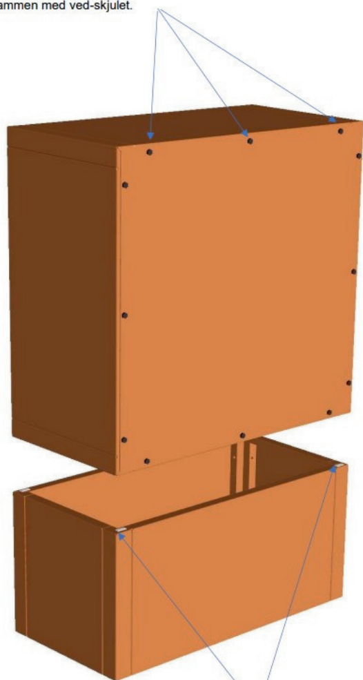
Magnetene er plassert på bunnboksen i hvert hjørne.
