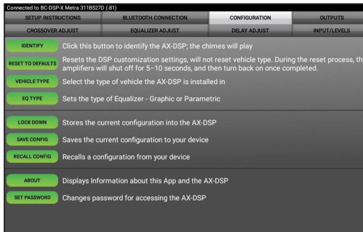
**RESTABLECIMIENTO A VALORES PREDETERMINADOS:** Reinicia la interfaz a sus configuraciones de fábrica. Durante el proceso de reinicio, los amplificadores se apagará entre 5 y 10 segundos.
