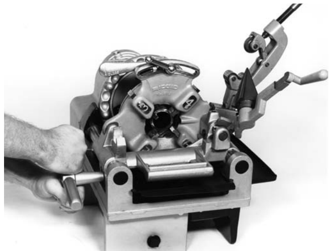
Figure 7 – Filetage des tuyaux avec la tête de filière n° 811-A
