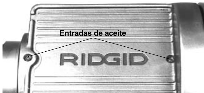
Figura 12 – Lubricación de los cojinetes
