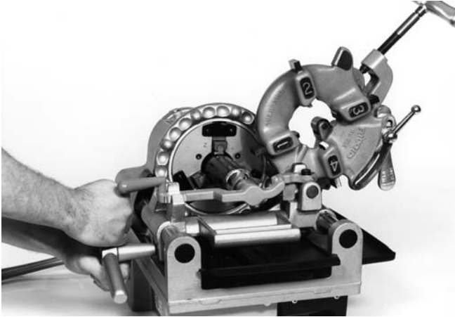
Figura 5 – Escariado de tubos con el escariador No. 344
