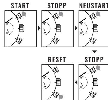
Neustart und Stopp der Stoppuhr können durch Drücken der Taste A wiederholt werden.
