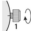
**ZUM VERSCHRAUBEN:** Drücken Sie die Krone ganz hinein (in Richtung der Uhr) und drehen sie dann im Uhrzeigersinn, bis sie fest verschraubt ist.
