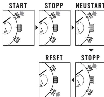
Neustart und Stopp der Stoppuhr können durch Drücken der Taste **A** wiederholt werden.
