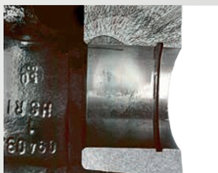
Fig.3 Sezione di un alesaggio del perno del pistone
