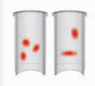
Usura non uniforme della superficie di scorrimento 70
