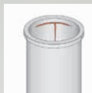
Collare della canna rotto sulla canna cilindro (stadio di ingresso) 66
