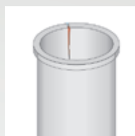
Cricche longitudinali nelle canne cilindro 65
