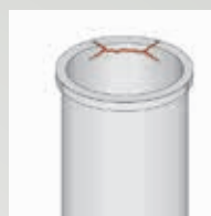
Cricca nella canna cilindro dovuta all'urto del liquido 74
