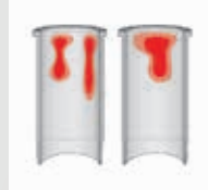
Punti lucidi nel settore superiore della superficie di scorrimento 72
