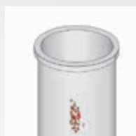
Cavitazione sulle canne cilindro 68
