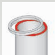
Collare della canna rotto sulla canna cilindro 66
