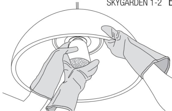
**ISTRUZIONI PER LA SOSTITUZIONE DELLA LAMPADA**
